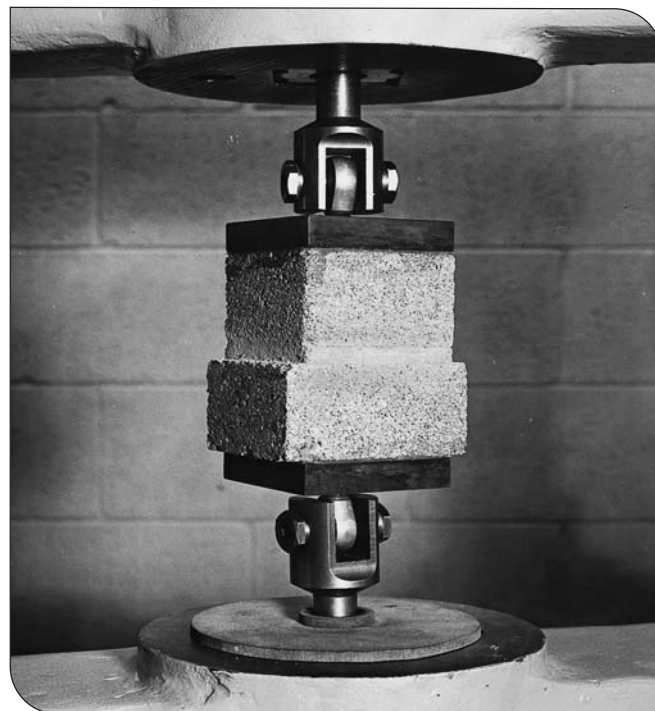
Fig. 3. Tensile bond test. (IMG14591)
